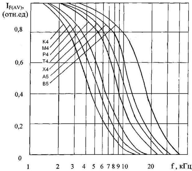
Рисунок 10: Зависимости максимально допустимого среднего прямого тока от частоты для указанных групп по времени обратного восстановления.
