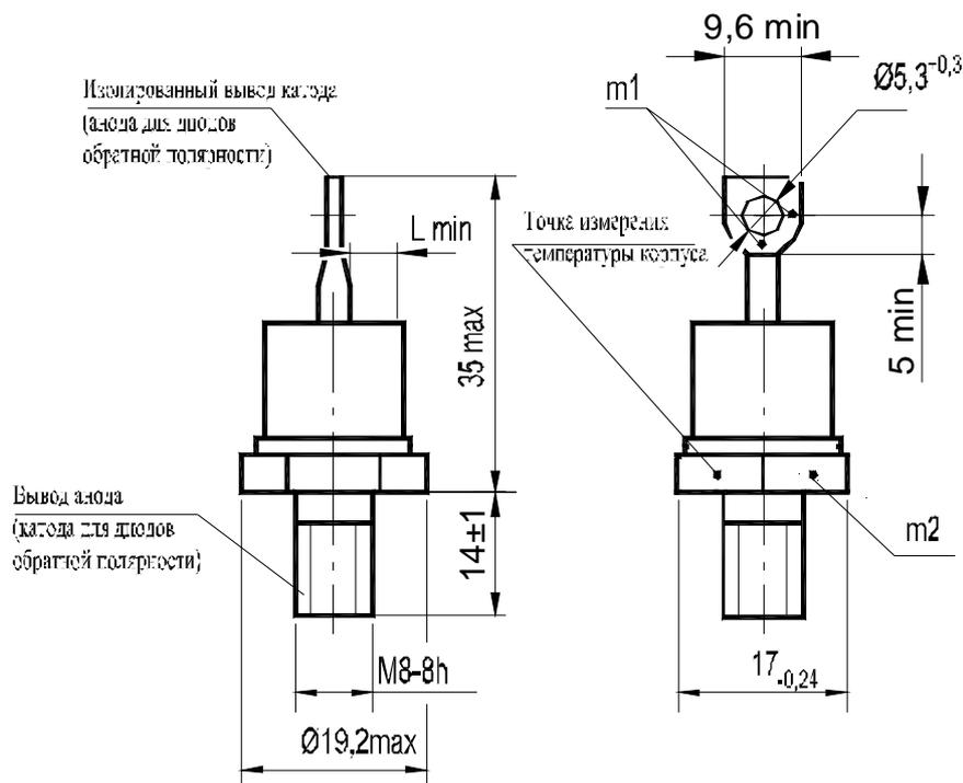
m1, m2 - контрольные точки измерения импульсного прямого напряжения, m1 - в одной из двух точек
