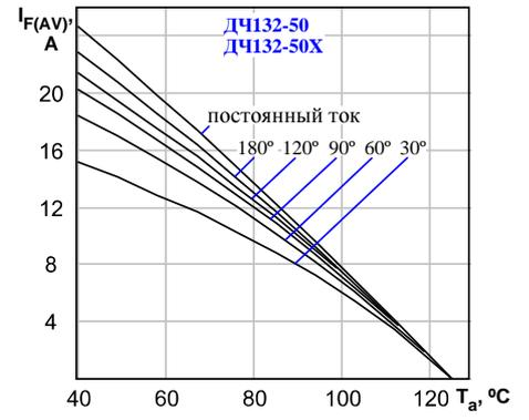
Рисунок 9: Зависимость допустимого среднего прямого тока  $I_{F(AV)}$  прямоугольной формы частотой 50 Гц при различных углах проводимости и постоянного тока от температуры окружающей среды  $T_a$  при естественном охлаждении на ОР331-80.
