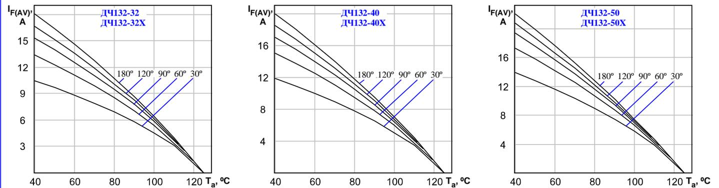
Рисунок 8: Зависимость допустимого среднего прямого тока  $I_{F(AV)}$  синусоидальной формы частотой 50 Гц при различных углах проводимости от температуры окружающей среды  $T_a$  при естественном охлаждении на ОР331-80.
